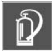
Jeder Feuerlöscher muss, um die Betriebsbereitschaft sicher zu stellen, alle 2 Jahre von einer Fachfirma überprüft werden. Die letzte Überprüfung bzw. die Fälligkeit der nächsten Überprüfung ist auf einem Aufkleber am Feuerlöscher festzustellen.
